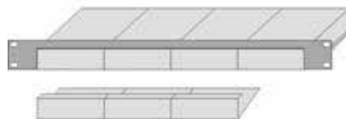
Einbau 4 Geräte mounting 4 devices
