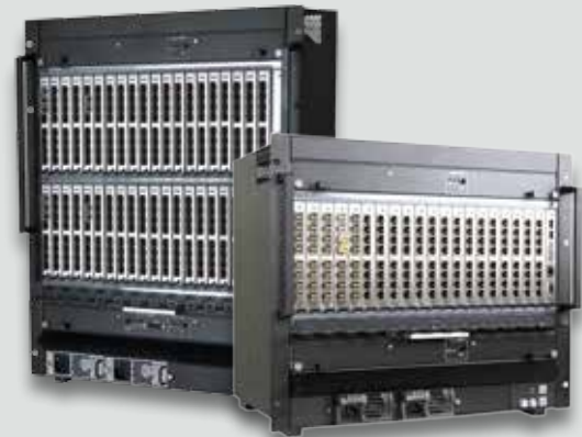
Das Draco tera Matrixsystem. Erhältlich in einem Größenspektrum von 8 bis 576 Ports.
